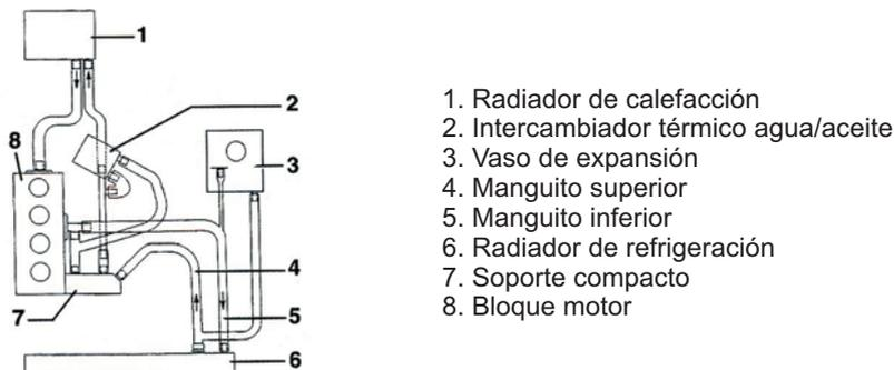
**Ejemplo del montaje en un motor Seat**
