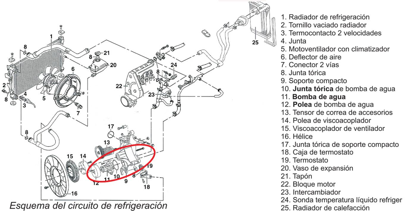
**Esquema del circuito de refrigeración (motores AHU, AHH y AFN)**
