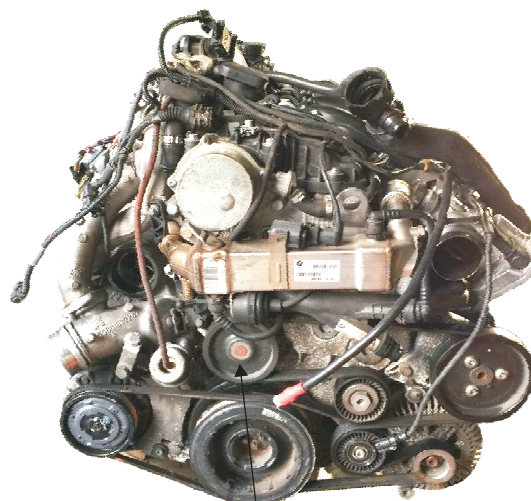
Bomba de agua
