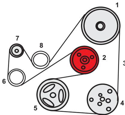
1. Polea de la bomba de servodirección
