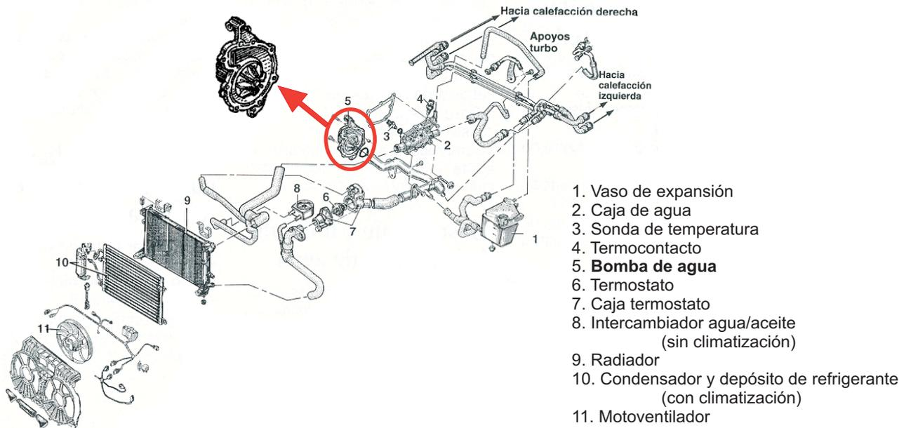
*Esquema de circulación del circuito de refrigeración*
