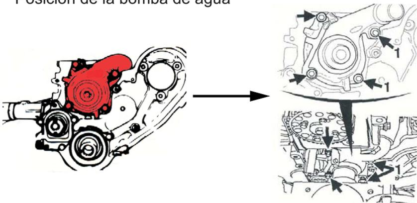
Tornillos de fijación que desmontan con el soporte sobre el motor
