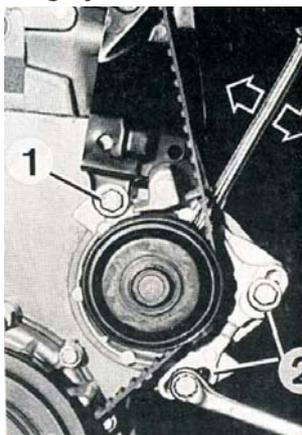
Para comprobar la tensión torcer la correa 90° con la mano, entre el árbol de levas y la bomba de agua. Si es necesario efectuar un reglaje, aflojar las fijaciones de la bomba y hacerla girar con una palanca. Ver imagen.
