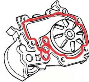
Bomba sin junta, zona de aplicación del sellante sobre la bomba de agua
